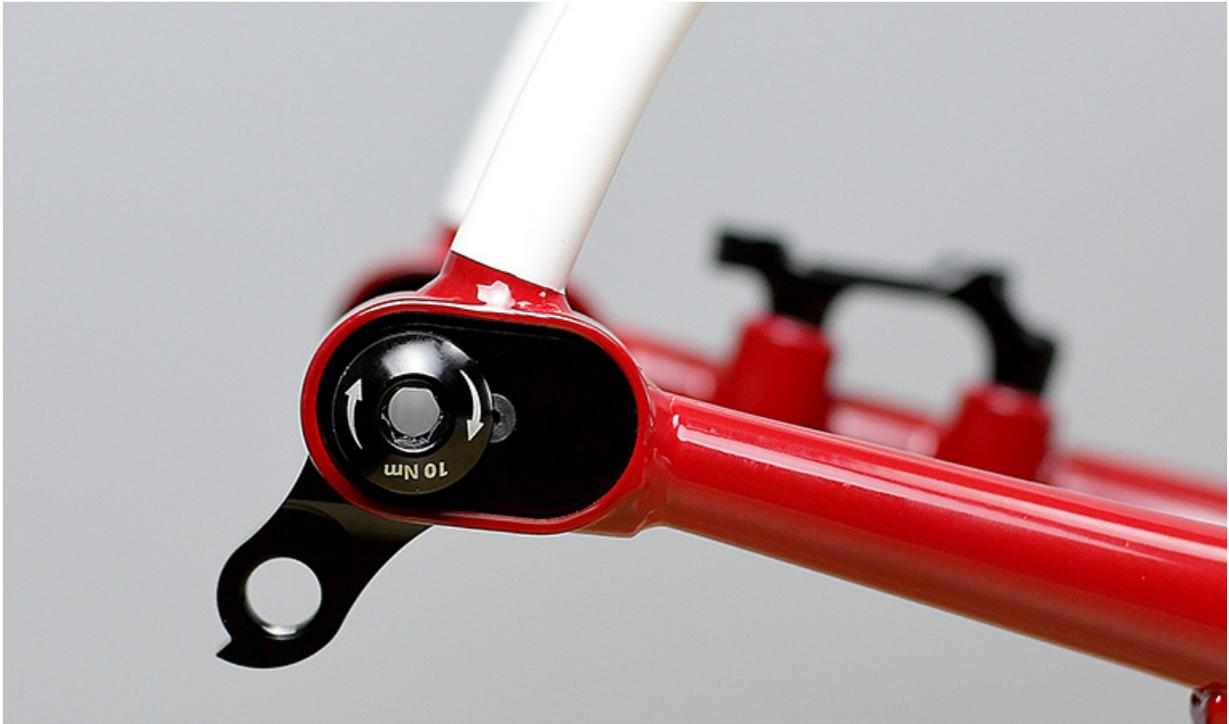
Sur le plan technique, le défi consistait principalement à permettre le positionnement correct de l'étrier de frein en version longue à partir d'un standard postmount 140mm en version courte. D'où la conception de ce petit adaptateur "PM140 Short to PM160 Long" qui s'intègre parfaitement à l'intérieur de la boucle arrière, et qui est naturellement livré avec tous les cadres.
