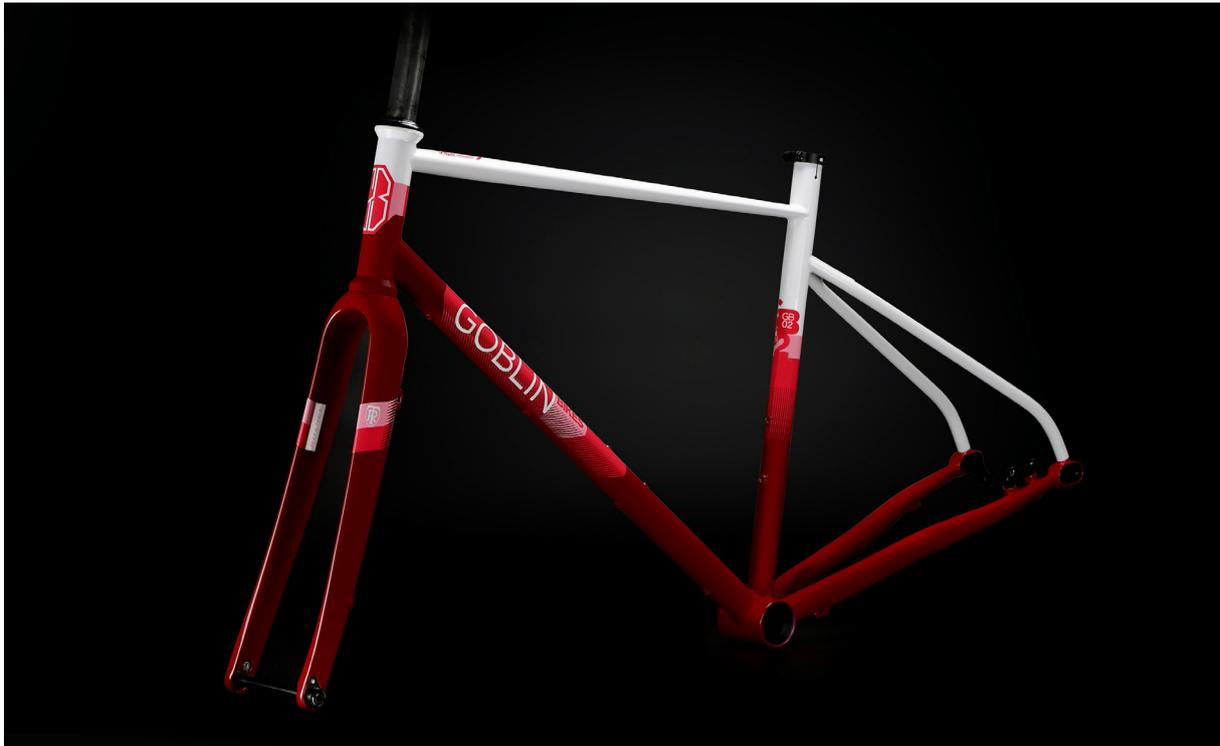
GB02 est un kit cadre en acier et fourche carbone destiné aussi bien à une pratique route endurance qu'à une pratique gravel, grâce à un système de dropouts réversibles.
